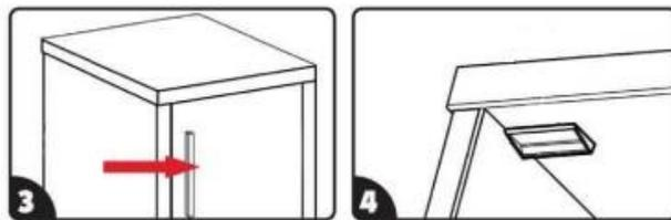
**Tipo 2:** la porta si chiude nel telaio del mobile (Figura 3). Spostate la serratura in profondità nel mobile in modo che la sua profondità corrisponda alla larghezza dell'anta del mobile (Figura 4).
