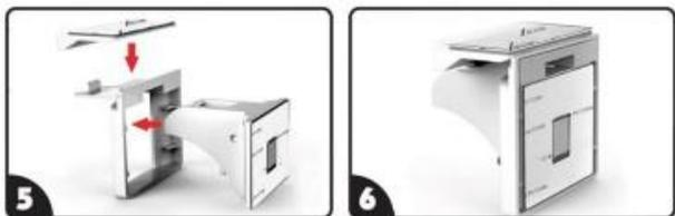
**2. Installazione della chiusura.** Collegare la chiusura e la serratura all'ausilio per l'installazione (Figure 5-6). Estrarre il retro della chiusura e della serratura. Posizionare l'ausilio di montaggio nella parte superiore/laterale del mobile. Chiudere il mobile. Rimuovere il supporto di montaggio.
